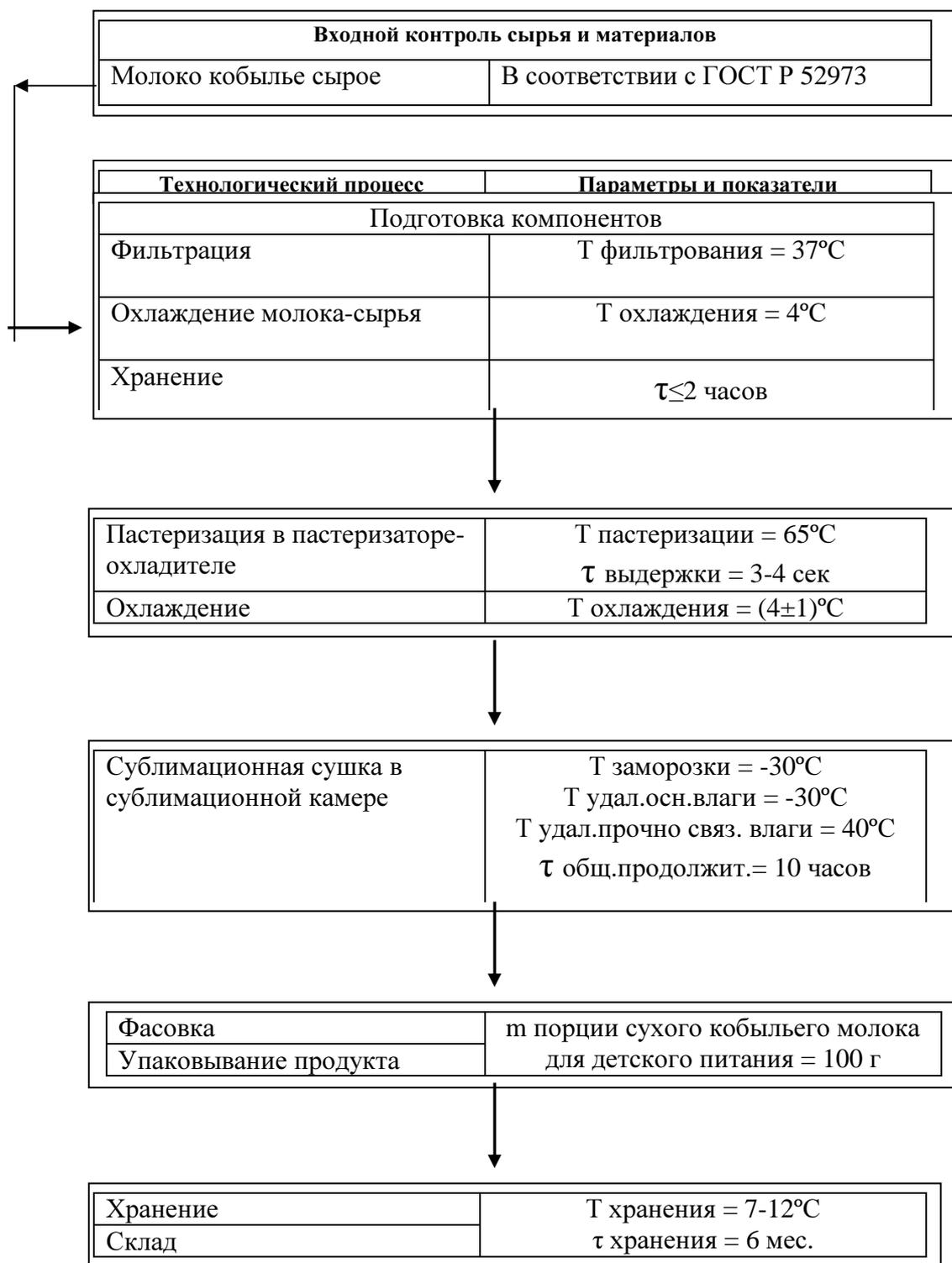
**Схема 1** - Технологический процесс производства сухого кобыльего молока для детского питания.
